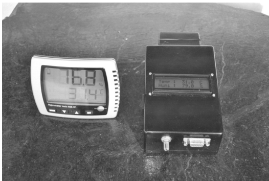
รูปที่ 5 การทดสอบความแม่นยำและความเที่ยงตรงในการใช้งานเทียบกับเครื่องรุ่น Testo 608-H1
