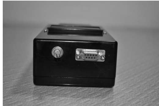
รูปที่ 4 ลักษณะของเครื่องบันทึกเพื่อตรวจติดตามอุณหภูมิและความชื้นสัมพัทธ์ต้นทุ่นดำที่พัฒนาขึ้น
