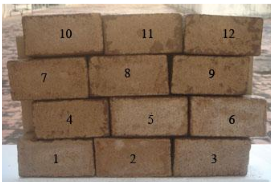
รูปที่ 1 ลักษณะการเรียงอิฐตัวอย่างที่ใช้ในการทดลอง
