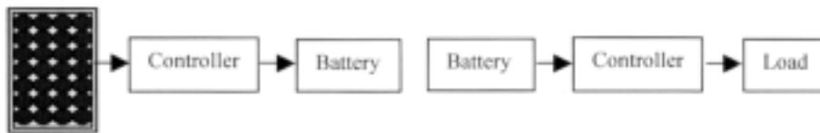
รูปที่ 2 (ก) แผนผังการประจุแบตเตอรี่
