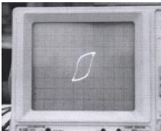
รูปที่ 3 ลักษณะวงวนฮิสเทอรีซิสของสารเซรามิกเลดเซอร์โคเนตไทเทเนต (PZT)
