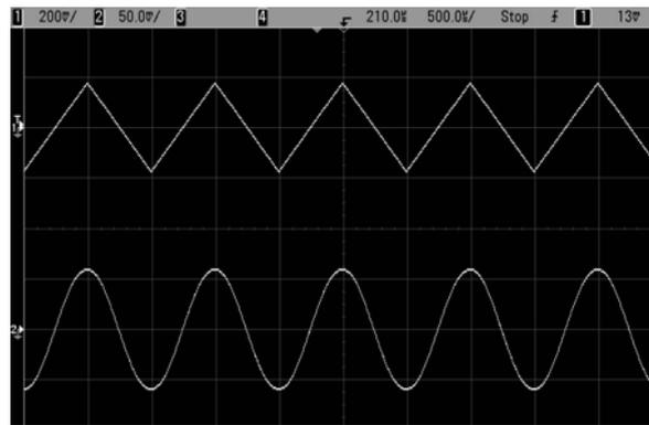
รูปที่ 9 ผลการทดลองโดยใช้ไอซีวงจรรขยายความนำเบอร์ CA3080
