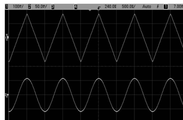
รูปที่ 11 ผลการทดลองโดยใช้ไอซีวงจรรขยายความนำเบอร์ LM13600
