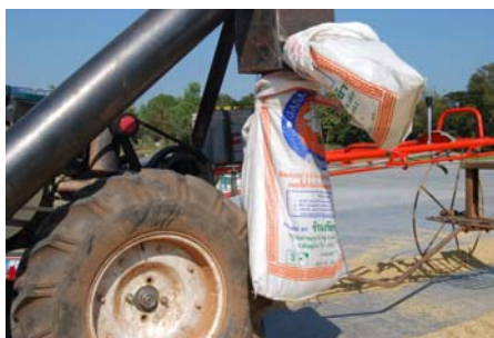
รูปที่ 20 สิ่งเจือปนที่มีน้ำหนักเบาจะออกสู่ถุงทางด้านข้าง
