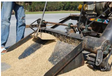
รูปที่ 15 ลักษณะการนำเมล็ดข้าวเปลือกเข้าสู่ท่อลำเลียง
