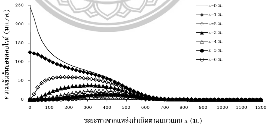
รูปที่ 6 กราฟได้จลสารจากการจำลองแบบการกระจายตัวของคลอไรด์จากน้ำชะขยะในน้ำบาดาลภายในพื้นที่ศึกษาที่ความลึกต่างๆ ในแกนพุ่ม ยิ่งลึกความเข้มข้นของคลอไรด์ในน้ำบาดาลยิ่งลดน้อยลง
