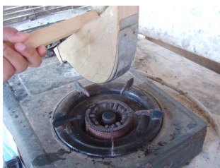
ภาพที่ 1 การตัดโค้งไม้ด้วยเตาแก๊ส
