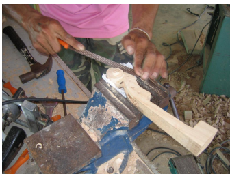
ภาพที่ 4 การตะไบแต่งหัวไวโอลินด้วยบุ้งขัดไม้
