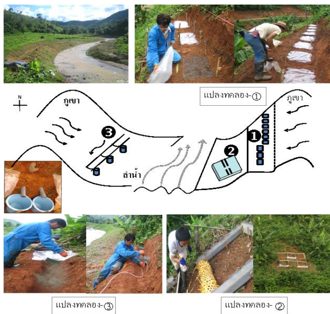
รูปที่ 1 แผนผังพื้นที่แปลงทดลอง 1) การใช้ถั่วลอยถั่วหนักตามแนวลาดชัน 2) สร้างอุปกรณ์ดักตะกอนจากเศษเซรามิคเหลือใช้จากโรงงานเซรามิค และ 3) การสร้างร่องน้ำดักตะกอนที่โครงสร้างดินแข็งแรง
