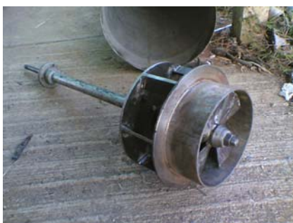
ภาพที่ 2 ใบกังหันน้ำขนาดเส้นผ่าศูนย์กลาง 0.20 m
