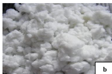
รูปที่ 2 a) เซรามิกไฟเบอร์ที่ยังไม่เสื่อมสภาพ และ b) เซรามิกไฟเบอร์ที่เสื่อมสภาพ
