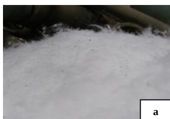
รูปที่ 2 a) เซรามิกไฟเบอร์ที่ยังไม่เสื่อมสภาพ และ b) เซรามิกไฟเบอร์ที่เสื่อมสภาพ
