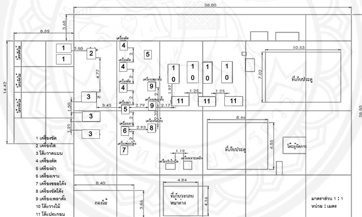
รูปที่ 7 ผังโรงงานหลังการปรับปรุง
