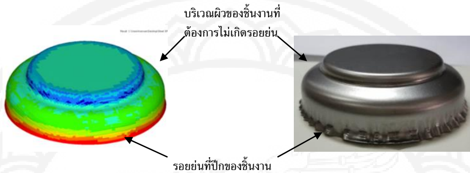
รูปที่ 7 ผลจากไฟไนต์เอลิเมนต์และการขึ้นรูปจริง
