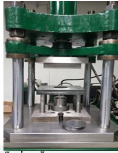
รูปที่ 6 เครื่องปั๊มที่ติดตั้งชุดแม่พิมพ์สำหรับขึ้นรูปชิ้นงาน
