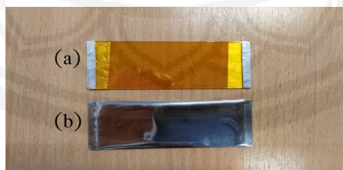
รูปที่ 2 (a) ภาพถ่ายแผ่นโพลีอิมิดและ (b) โพลีอิมิดที่เคลือบด้วยฟิล์มบิสมีสเทลลูไรด์
